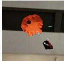
この写真は実験時のものであり、学校の四階から落下させ、降下速度や強度を実験している。
